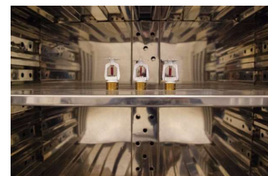
آزمون های مقاومت به دمای بالا مطابق استاندارد DINEN 12259
