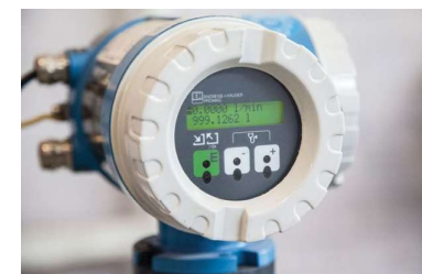
دبی سنجی تعیین ضریب K-Factor مطابق با استانداردهای UL 199 و DINEN 12259
